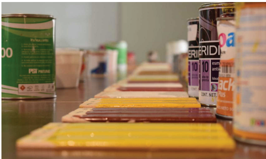
Figura 5. Aplicación de pintura en tablillas de madera no tratada químicamente. Fuente: Fotografía - Casa Cem
